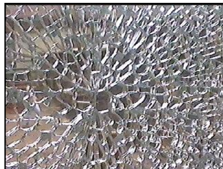
Gambar 15 - Gambar pecahan kaca diperkeras
