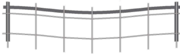
Gambar 12 – Efek Penurunan Struktur Lantai Pada Selubung Bangunan (CWCT TN56, 2007)
